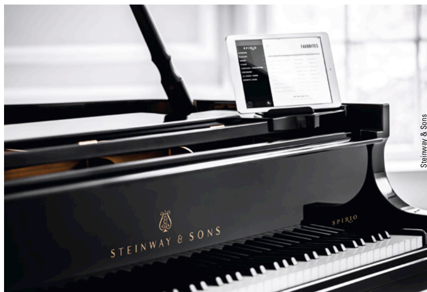
De Steinway Spirio werkt met elektromagneten. De 88 hamers worden aangestuurd door magneetspoelen die heel snel aan- en uit kunnen.
