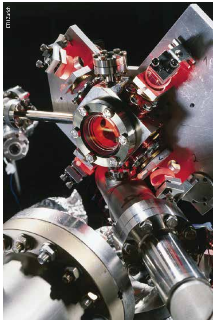
Bij kwantumcomputers worden vaak neutrale atomen gebruikt als qubits. Om de atomen voldoende af te koelen (tot bij het absolute nulpunt van -273,15^\circ\text{C} ), bedienen onderzoekers zich van laserlicht uit een zogeheten magneto-optische val.
